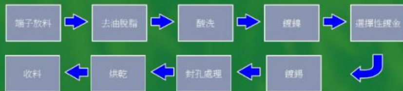
连续镀生产线
